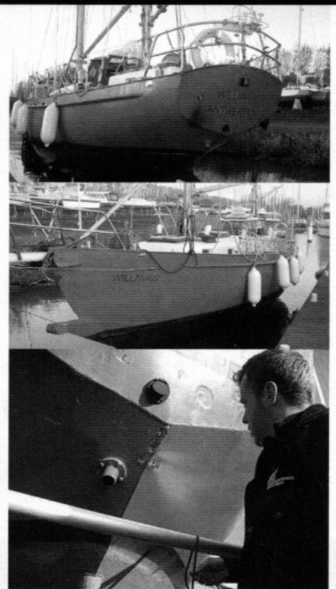
Yelle Annemans aan het werk bij de plaatdiktemeting
